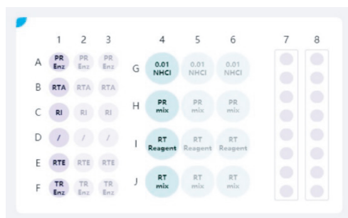
图 2-6 低温试剂台面放置示意图
